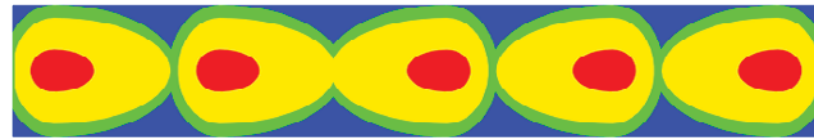
Répartition de la chaleur d'un système de chauffage courant de type tubulaire* Notez les grandes zones bleues, froides et les zones rouges très chaudes
